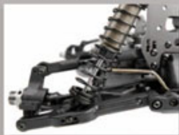
Sospensioni completamente regolabili per ogni tipo di terreno
